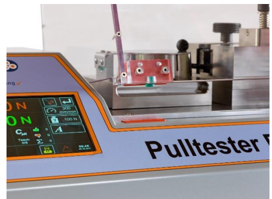
Sicherheitsabschaltung bei geöffneter Schutzhaube und Fingerabdruck-Scanner
